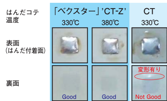
※上記の写真は「ベクスター」50 μmと圧延銅箔18 μmのCCLから2mm角の銅パッドを形成し、その上に鉛フリーはんだをはんだコデによりのせたもの
